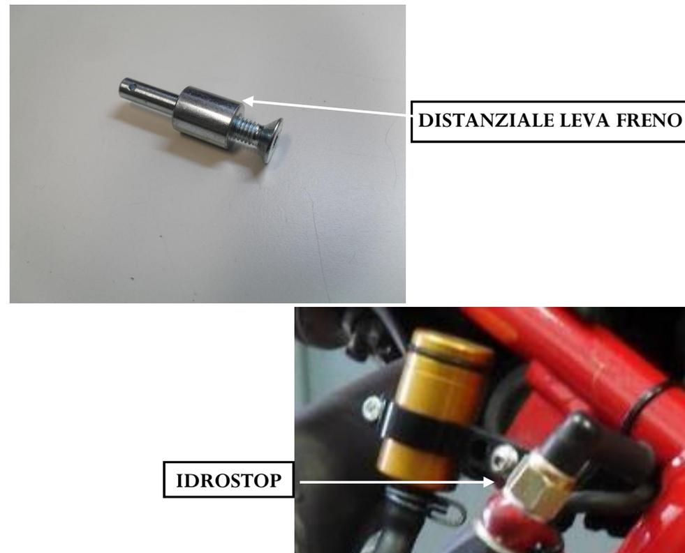
Usare il distanziale fornito nel kit per unire la pompa freno alla leva freno.
