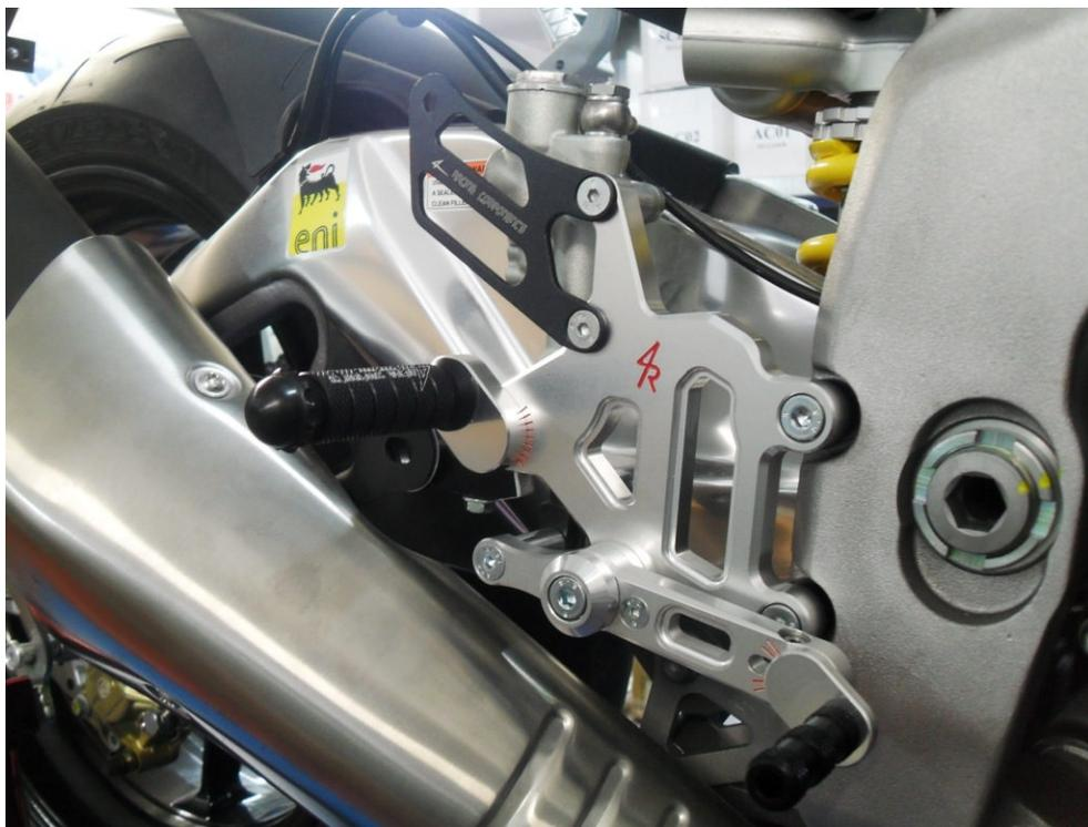
**Rimuovere le pedane originali e montare la pompa freno alla pedana 4Racing con le viti contenute nel kit.
